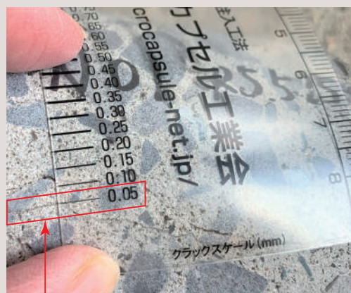
低圧により 0.05 mm にも充填されている
